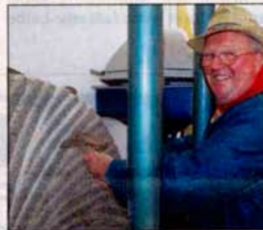
Ewald Stumpe demonstrierte, wie ein Mühlstein geschärft wird.
